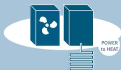
Die Erzeugung von Wärme oder Kälte aus Strom ist eine weitere Flexibilisierungsoption für eine erneuerbar dominierte Energieversorgung und wird als POWER-to-HEAT bezeichnet. Dabei wird regenerativ erzeugter Strom in Wärmepumpen und Heizstäben zur Wärmebereitstellung oder in Klimaanlage zur Kühlung eingesetzt. Eine unmittelbare Nutzung im Haushalt ist ebenso vorstellbar wie die Einspeisung von Wärme/Kälte in ein Versorgungsnetz für einen entfernten Nutzungsverbund.
