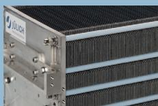
Der abgebildete Direktmethanol-Brennstoffzellenstapel (DMFC) ist Teil eines Hybrid-systems zum Batterieersatz in der leichten Traktion. Die elektrische Nennleistung beträgt 1,3 kW (Peak: 3 kW). Der Stapel besteht aus 90 Zellen mit je 315 cm<sup>2</sup> aktiver Fläche. Die Bipolarplatten bestehen aus expandiertem Graphit. Der kathodische Druckverlust liegt unter 2 mbar, so dass ein Gebläse zur Luftversorgung genutzt werden kann.
