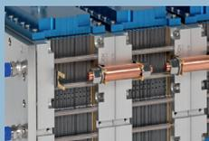
Der abgebildete Hochtemperatur-Polymerelektrolyt-Brennstoffzellenstapel (HT-PEFC) besteht aus insgesamt 30 Zellen. Bei einer aktiven Zellfläche von 320 cm<sup>2</sup> beträgt die maximale, elektrische Leistung etwa 2 kW. Als Besonderheiten sind der modulare Aufbau und das zweischalige Bipolarplatten-Design mit integrierter Temperierung zu nennen.
